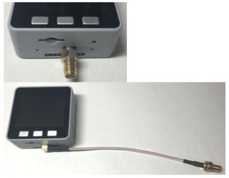
MCXコネクタは構造上、性能が保証される脱着の回数は少なくて、500回程度です。 そのため、アンテナの脱着はSMA側で行うようにして下さい。
