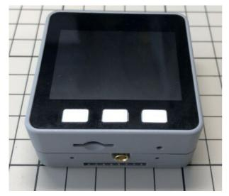
M5StackはこのようにCoreとBottomの間に色々な機能のモジュールを挿入し、積み重ねていく事で欲しい装置を作る事ができます。
