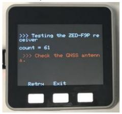
3回以上"Retry"ボタンを押しても受信できない場合、空が見渡せる屋外でテストして下さい。 それでも受信できない場合は弊社にご連絡下さい。
