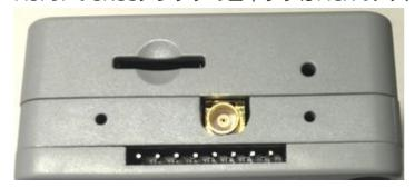
RTK用のアンテナのコネクタはSMAオスが多く、接続するためにはSMAメス-MCXオス変換コネクタが必要です。
