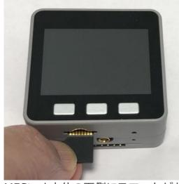
M5Stack本体の下側にスロットがあり、画像のようにマイクロSDカードの裏面を上に向けて、電極が見える状態で挿入します。
